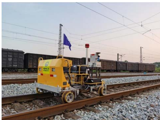
铁路既有線移动扫描测量
